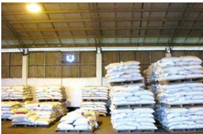
Figura 38b. Alimento almacenado temporalmente en estibas de una bodega en una granja camaronera. Nótese las condiciones de ventilación, iluminación y limpieza de la bodega; así mismo, el uso de tarimas de madera y el orden y espacio en el sistema de estibas. Foto cortesía del Dr. J. Cuéllar-Anjel.
