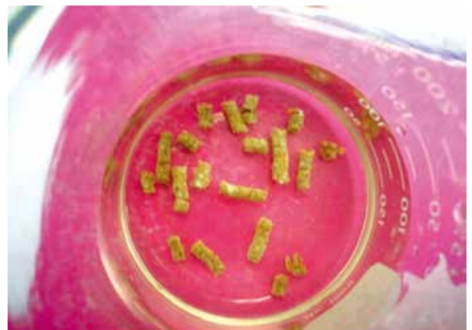
Figura 39. Prueba de hidroestabilidad realizada a una muestra de un lote de alimento a su llegada a la granja camaronera, con el propósito de evaluar su calidad física. Los pellets se han sumergido en agua de mar dentro de un vaso volumétrico (beaker), sin agitación. Nótese la hidratación y consistencia de los pellets después de 2 horas de evaluación. Foto cortesía del Dr. J. Cuéllar-Anjel.
