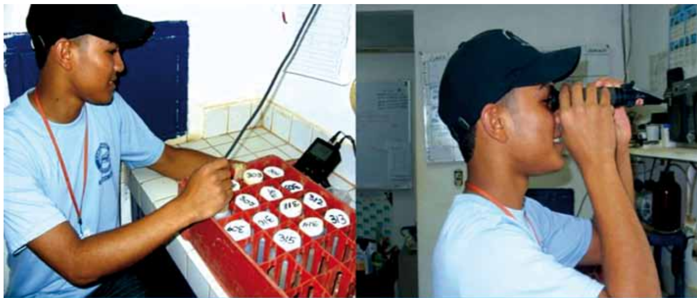
Figura 43. Análisis rutinario de agua de estanques en una granja camaronera, en el cual se está midiendo pH (izquierda) y salinidad (derecha). Fotos cortesía del Téc. C. Coronado.
