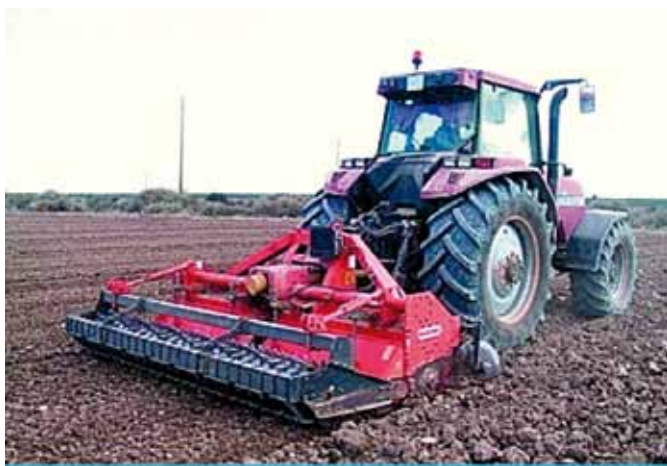
Figura 32. Tractor tirando de un rotovator durante la preparación de un estanque para la siembra. Foto cortesía del Dr. J. Cuéllar-Anjel.
