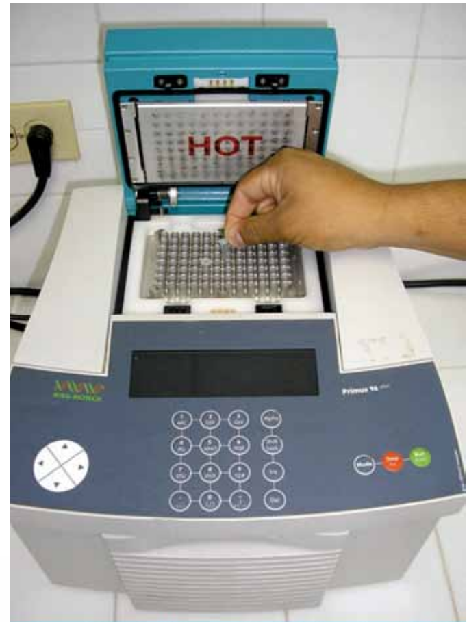
Figura 56c. Aparato de PCR (termociclador), utilizado para la amplificación genómica (ADN o ARN) de agentes patógenos de camarones a partir de muestras de tejido. Foto cortesía del Dr. J. Cuéllar-Anjel.
