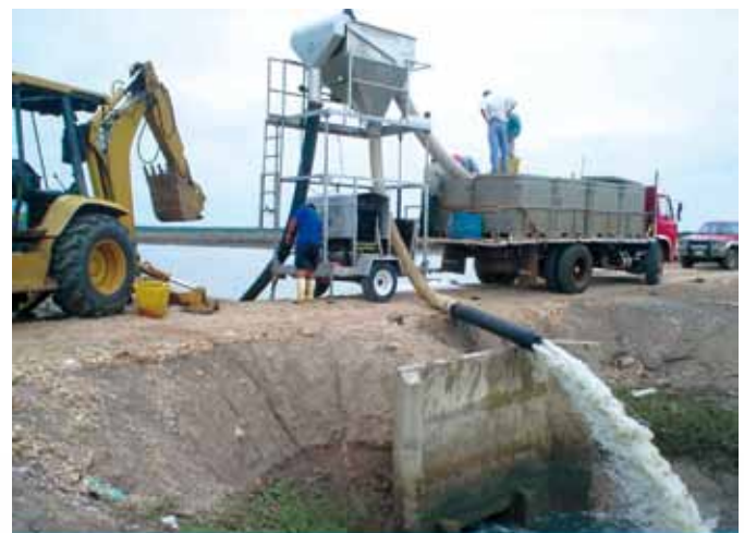
Figura 60. Uso de una bomba de cosecha en un estanque de una granja camaronera, equipo con el cual se logra una mejor calidad del producto. Foto cortesía del Dr. J. Cuéllar-Anjel.
