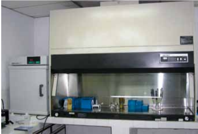
Figura 56a. Incubadora con temperatura controlada (izquierda) y cabina de flujo laminar Clase II, utilizadas para estudios de bacteriología en el laboratorio de una granja camaronera. Foto cortesía del Dr. J. Cuéllar-Anjel.
